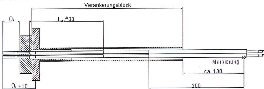
Abbildung 2: Schutzhülle nach dem Straffen beim Festanker
