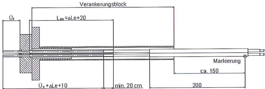
Abbildung 1: Schutzhüllen und Spannglied nach Straffen beim Spannanker
