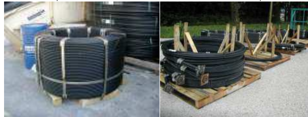
Monolitzen in großen Lagen vor Verarbeitung zu VBT-BI- Spannbändern
