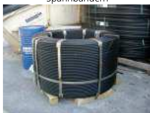
Monolitzen in großen Längen vor Verarbeitung zu BE-Spannbändern
